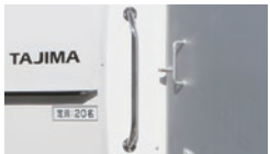
(6)乗降手すり(外側)
